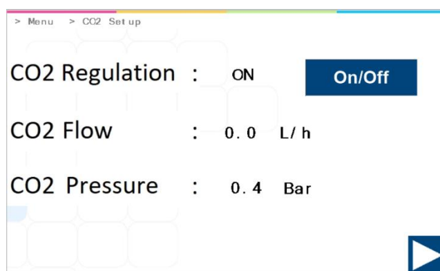
Figura 13.25 Schermata del sottomenu di impostazione CO 2 negli incubatori multicamera IVF MIRI® TL6 e MIRI® TL12
