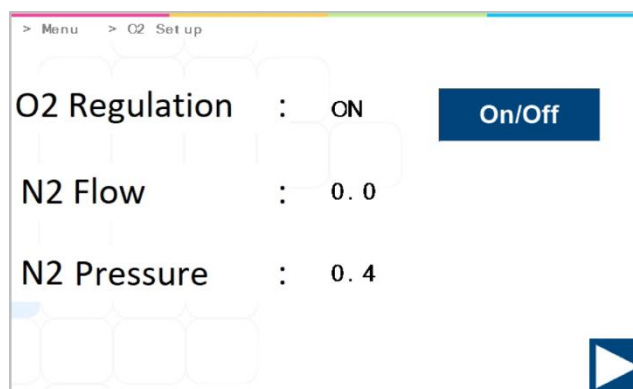
Figura 13.26 Schermata del sottomenu di impostazione O 2 negli incubatori multicamera IVF MIRI® TL6 e MIRI® TL12
