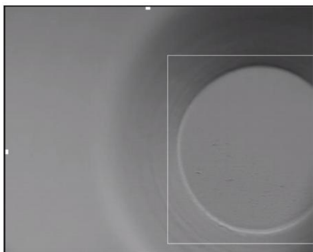
Figura 20.38 Esempio di una posizione non corretta del pozzetto nella schermata di visualizzazione della telecamera
