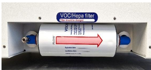
Figura 12.3 Filtro VOC/HEPA installato correttamente
