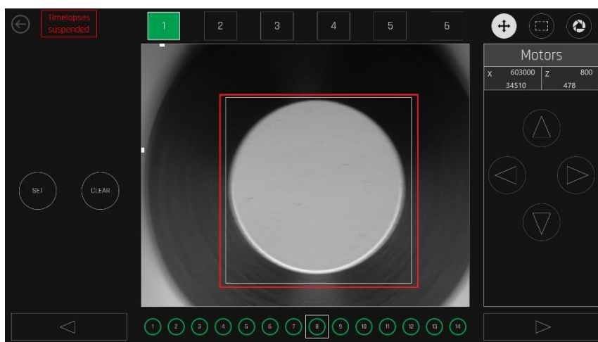
Figura 20.41 Posizione del pozzetto all'interno del limite del riquadro contrassegnato
