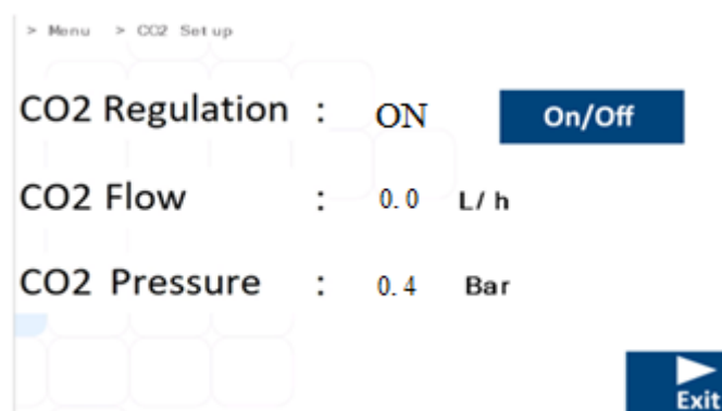
Figura 16.2 Schermata del sottomenu di impostazione CO 2 degli incubatori multicamera IVF MIRI® TL6 e MIRI® TL12
